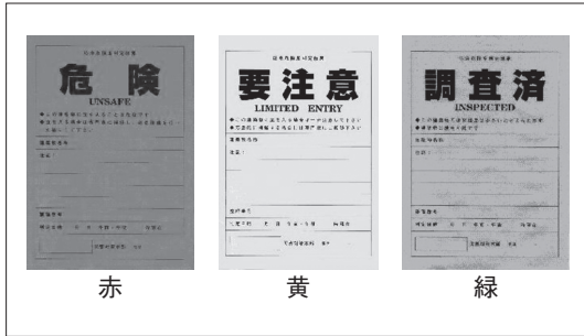
図Ⅷ-10 応急危険度判定
